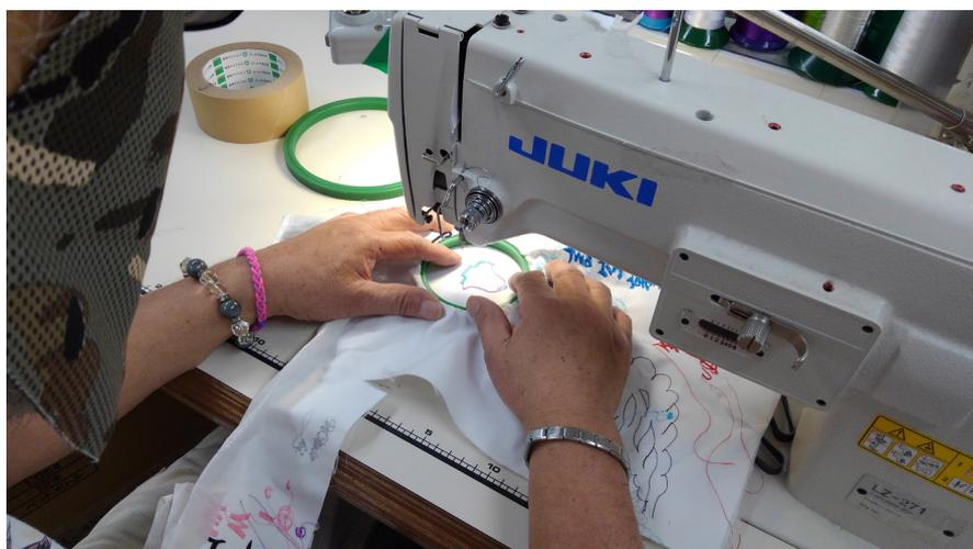
足のペダルで針のスピード調整、右ひざで針の振れ幅を調整しながら手を細かく動かし、文字や絵を縫い付けていく
